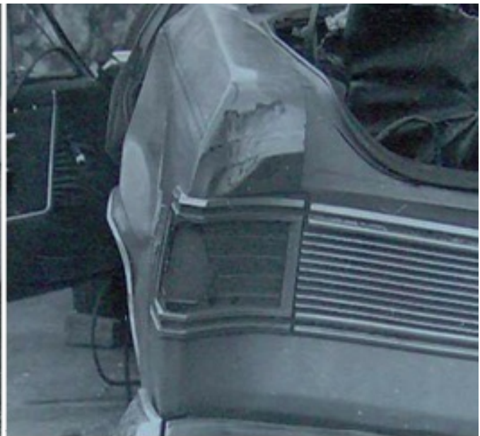
À esquerda, no local do acidente, foto tirada pelo primeiro perito: a lanterna traseira esquerda e o ângulo superior do para-lama traseiro intactos. À direita, já no pátio da delegacia, com assinatura do novo perito, tanto a lanterna como o para-lama danificados
